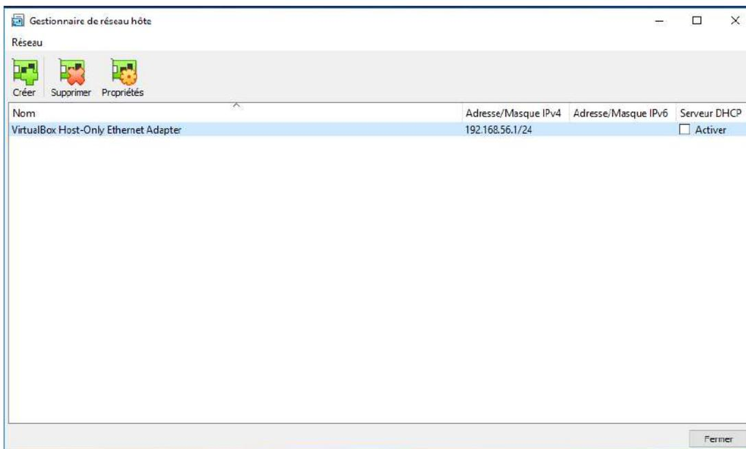
Enfin, s'assurer dans les paramètres réseaux des machines virtuelles que les cartes réseaux définies en mode réseau privé hôte sont correctement liées à vboxnet0 ou VirtualBox Host-Only Ethernet Adapter.
