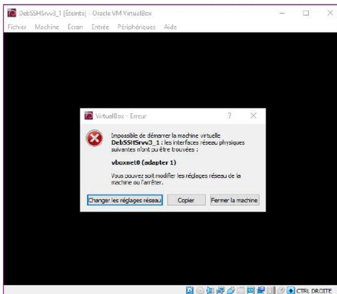
Il suffira de cliquer sur « Changer les réglages réseau » et de valider la prise en compte du « VirtualBox Host-Only Ethernet Adapter » à la place de « vboxnet0 » pour régler le problème.
